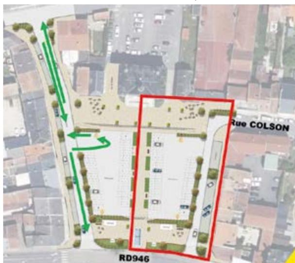
Le chantier sera divisé en deux phases, tel que décidé en réunion, avec l'approbation des commerçants du centre-ville. Chaque phase consistera en l'enfouissement des réseaux (électricité, téléphone, etc.), le nivellement, l'installation de systèmes d'infiltration et de récupération des eaux plu-
